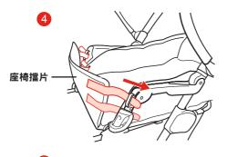
4 首先讓後方座席平躺後,將座椅檔片兩側的魔鬼氈(上方)穿過腳管前方的固定孔以及魔鬼氈(下方)繞過腳管後固定。
