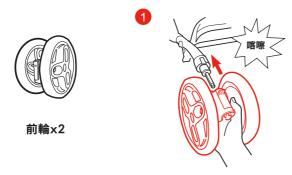
●請依圖示方向安裝,直到聽見"喀嚓"聲為止。相同步驟安裝另一側車輪組。 安裝完畢,請用力試拉車輪組,確認已經牢固安裝不會脫落。
