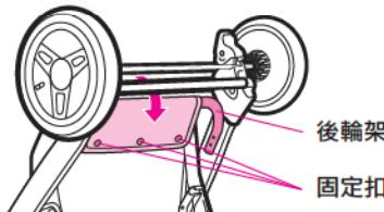
⑥ 將置物籃後側布料包覆著後輪架，3處固定扣扣在後輪管上，拉動2~3次，確認已確實地安裝妥當。
