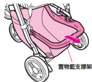
① 將置物籃上面後方的置物籃支撐架往後拉。
