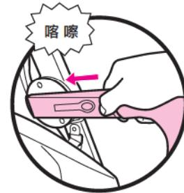
⑧ 插入安全扶手(左右)，直到發出「喀 嘭」聲，拉動2~3次，確認已確實地安裝妥當。
