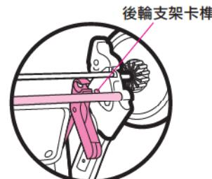
⑦ 對準後輪支架上的卡榫，將支撐立架嵌入後輪支架上，拉動2~3次，確認已確實地安裝妥當。
