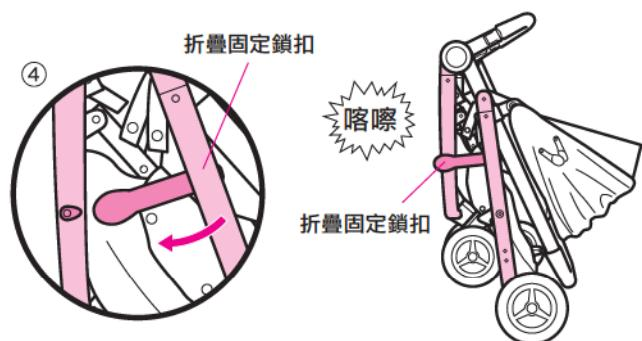
④ 將車體架往箭頭方向動作，直到發出「咯喀」聲，拉動2~3次，確認已確實鎖定。
