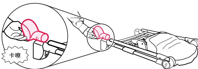
① 將前腳管上的凸出鈕對準腳管固定套插入，直到聽見“卡嚓”聲為止。（兩側）
