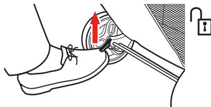
1 請將後輪煞車器鎖桿向下壓即可上鎖。
